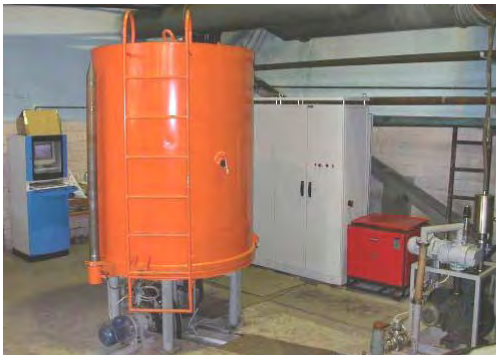
Участок ИПА, оснащённый установкой УА-63-1150/1400 (2005 г.)
