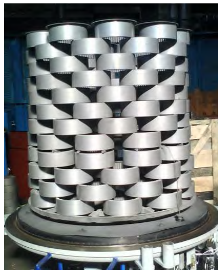
Рис. 2. Шкаф управления установки (а), шестерни 5440-2405050 в камере установки (б)
