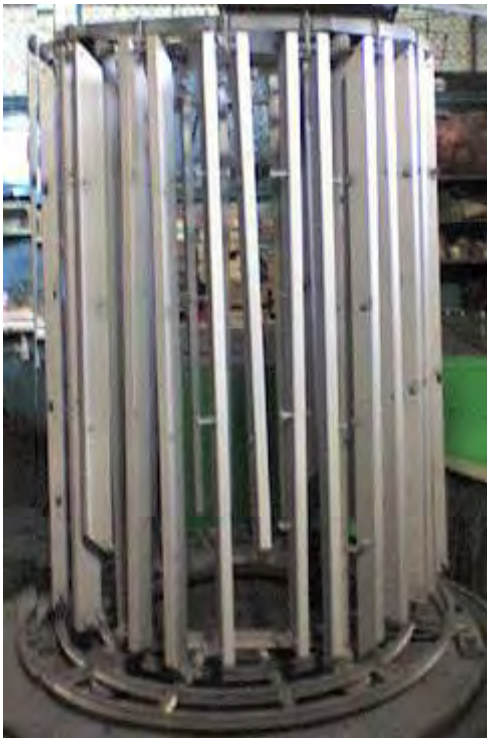
Направляющие рейки для прокатных станов, сталь45
