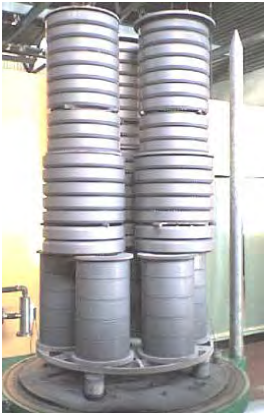
Шестерни для автомобилей МЗКТ различных моделей, обрабатываемые в одной садке, сталь 40Х
