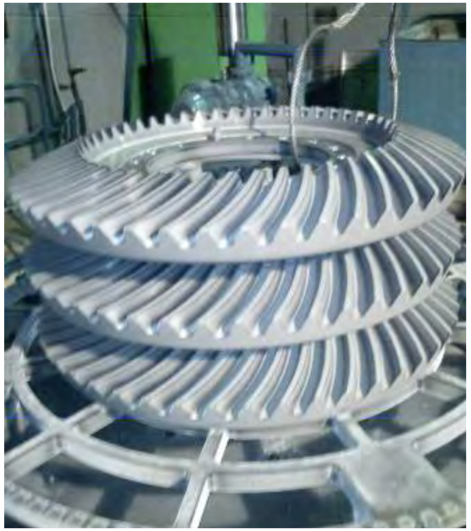
Скалки для термопластавтоматов и косозубые шестерни, сталь 38Х2МЮА
