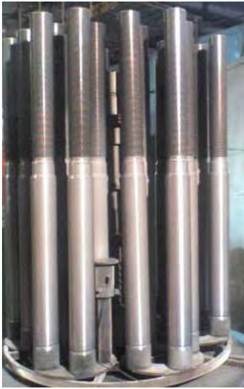
Скалки для термопластавтоматов и косозубые шестерни, сталь 38Х2МЮА
