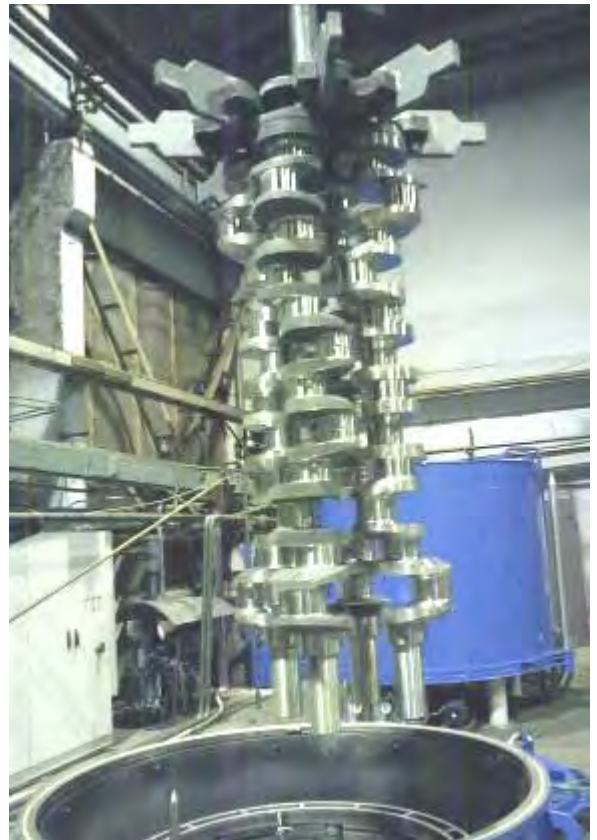
Загрузка коленчатых валов в камеру шахтного типа, сталь 38ХНЗМА, ЗАО «Волжский дизель» (Балаково)
