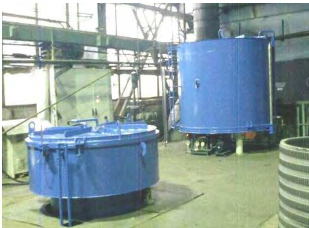
Участок ИПА, оснащённый установкой УА-63-1150/1400 (2005 г.)
